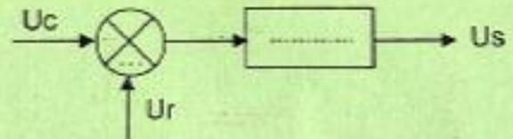
c- On donne ci-dessous le schéma fonctionnel de l'asservissement du moteur.
